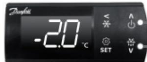
PARA CIMA/PARA BAIXO: altera o setpoint de temperatura (no modo de configuração, o setpoint fica intermitente).
