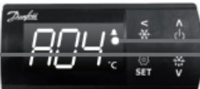
Os códigos de temperatura e alarme ficam piscando até que o alarme seja resolvido.
