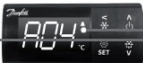
*I codici di temperatura e di allarme lampeggiano alternativamente fino a quando il problema correlato all'allarme non viene risolto.*
